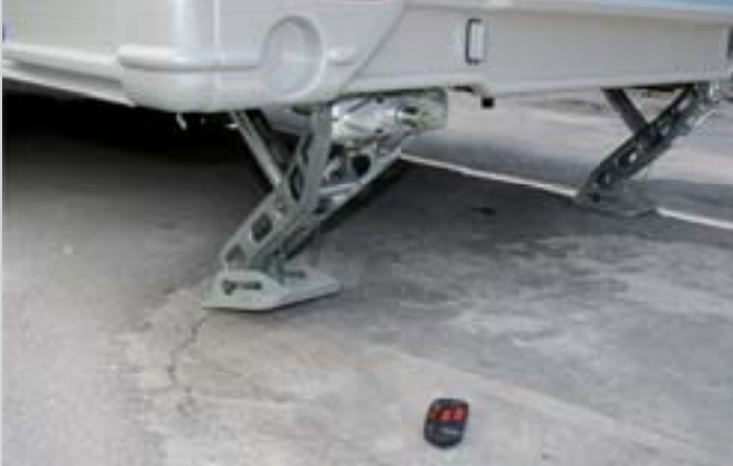
Patas niveladoras motorizadas a 12V.
