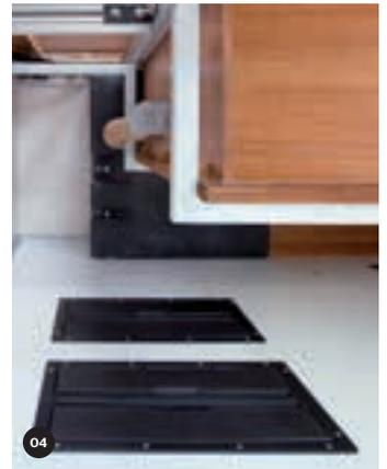
**Les batteries** sont logées dans le double plancher sans perte de place (Profila T : en dessous du siège passager).
