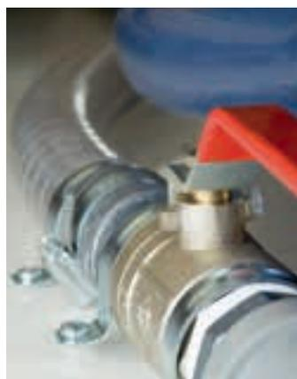
Les robinets d'arrêt d'eau hors gel dans le double plancher chauffant, la preuve que le Terrestra T ne craint pas l'hiver.
