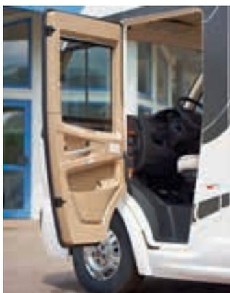
La porte cabine avec double verrouillage (mis en service par interrupteur) et grand angle d'ouverture.
