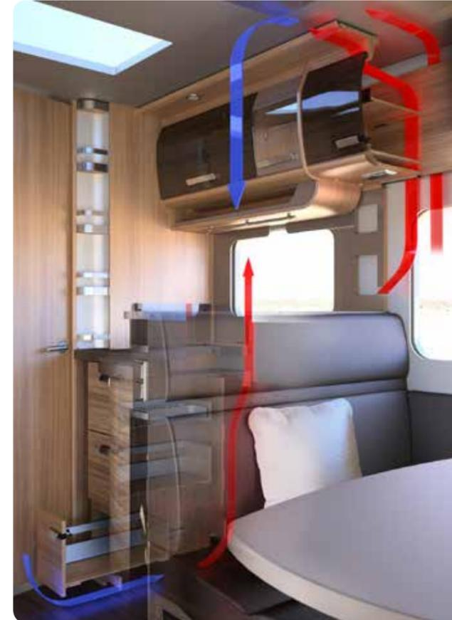
**+ Aufwändig.** Möbel in Integralbauweise für ideale Hinterlüftung und ein optimales Raumklima.
