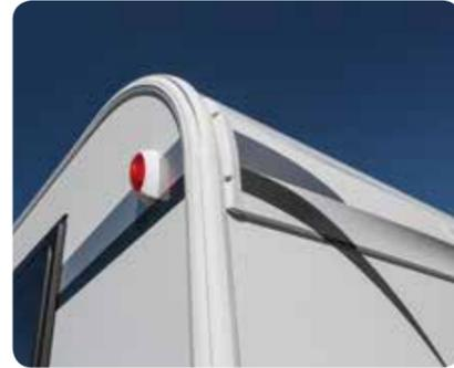
**+ Robust.** Umlaufende Aluminium-Profilleisten für perfekten Kantenschutz dank Pro.tec-Frame.
