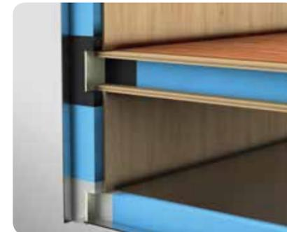
**+ Isoliert.** Doppelbodenkonstruktion mit serienmäßiger Unterbodenschutzschicht aus GFK.
