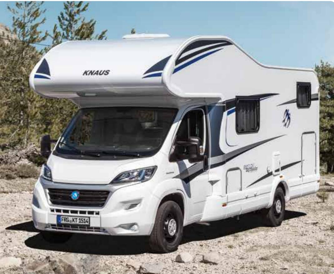
**+ Charmatisch.** Der SKY TRAVELLER ist eine imposante Erscheinung. Und das natürlich in bewährter KNAUS-Qualität. Stabile Aluminium-Seitenteile schützen die Seitenwand, elegante Formteile verbinden Fahrerkabine und Aufbau.
