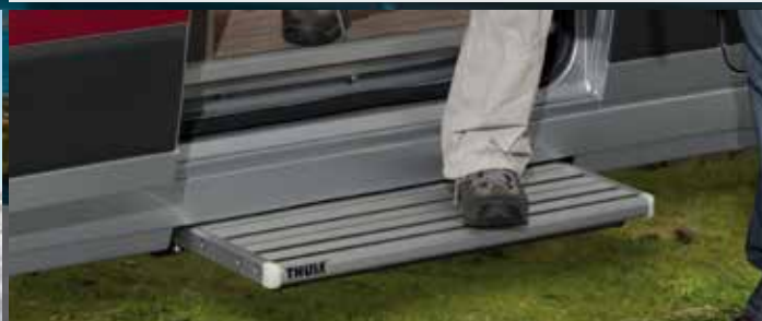
Elektrische Stufe Für Aussteiger, die gerne bequem einsteigen: Ein Knopfdruck genügt und die Trittstufe fährt aus.
