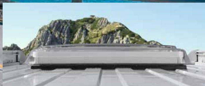
GFK Dachfensterrahmen Wir setzen ausschließlich sorgfältig abgedichtete und solide Adapterrahmen aus GFK ein.
