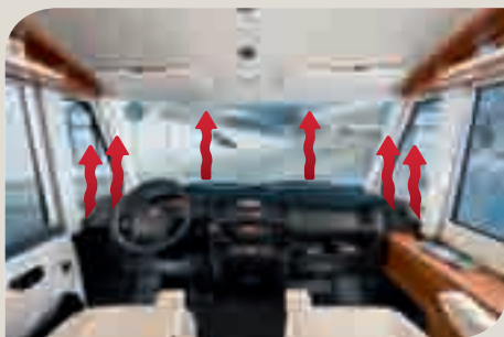
► Salpicadero con canal de aire interior para descongelar rápidamente la luna (pág. 120)
