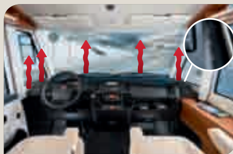
► Salpicadero con canal de aire caliente para descongelar rápidamente la luna
