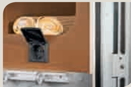
► Toma de corriente de 230 V y anillas sujeción en el garaje trasero
