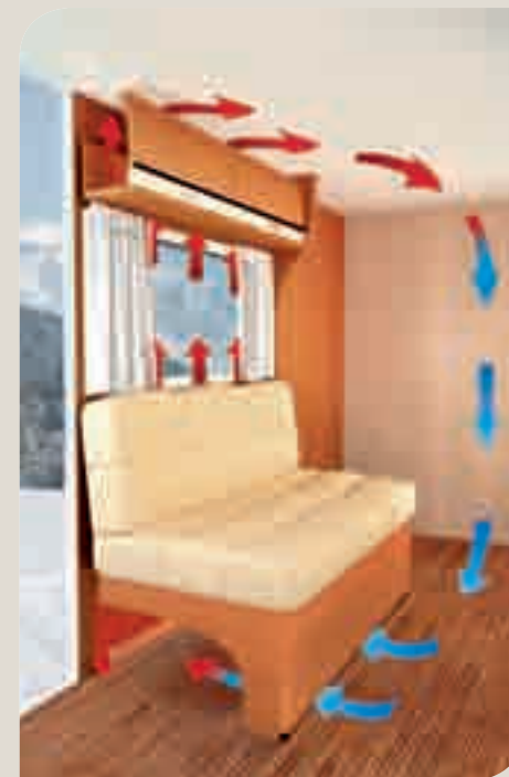
► Excelente clima interior con el sistema "Air Plus" (circulación de aire detrás de armarios altos)
