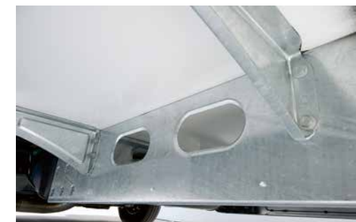
+ Lifetime-Plus de Dethleffs: construcción suelo inferior sin costillaje de madera con revestimiento de GFK
