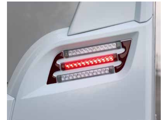
+ De fácil reparación : parachoques trasero de varias piezas con luces de LED integradas
