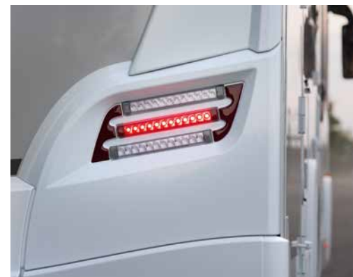
+ De fácil reparación : parachoques trasero de varias piezas con luces de LED integradas
