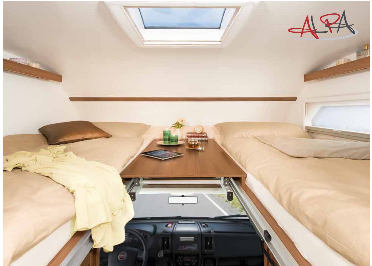
+ A 6820-2: Alkoven con dos cómodas camas individuales. El acceso a la cabina se puede cerrar y bloquear completamente
