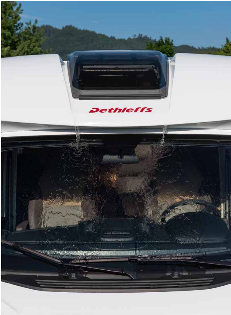
+ Canalización del agua de lluvia que cae sobre el techo
