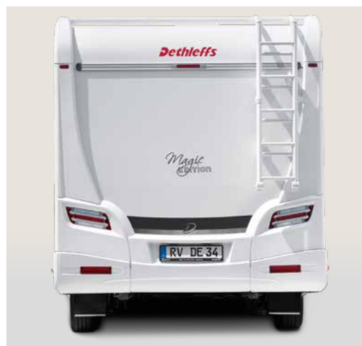
+ Parachoques trasero compuesto de varias piezas con pilotos de LED integrados (imagen versión Black)
