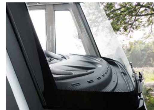
+ Un canal de aire adicional de la calefacción evita que la luna frontal y las ventanillas laterales se empañen o congelen
