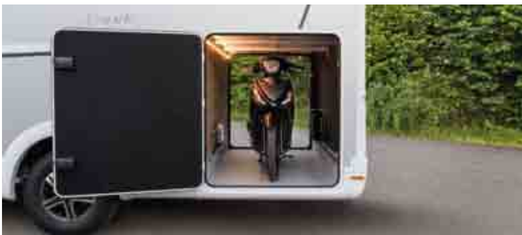
+ Ahí cabe de todo: garaje trasero alto con una capacidad de carga de 250 kg y doble portón. Perfectamente iluminado mediante tira de luces de LED.
