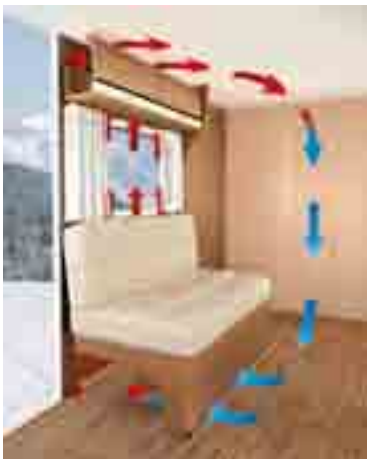
+ Sistema "AirPlus": circulación de aire detrás de los armarios altos
