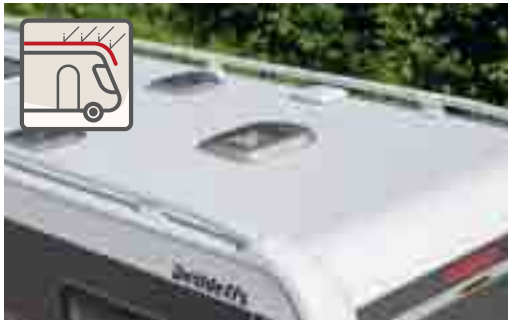
+ Techo de GFK: resistente al granizo
