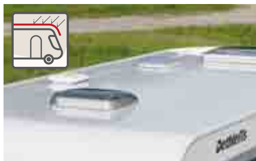
+ Techo GFK: resistente al granizo
