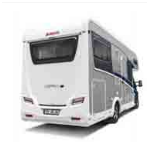
+ Fácil de reparar: trasera compuesta de diversas partes con pilotos LED de bajo consumo
