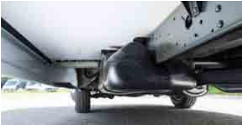
+ Subsuelo revestido de GFK
