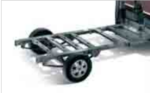
+ Chasis Fiat rebajado de vía ancha para una mayor seguridad sobre el asfalto
