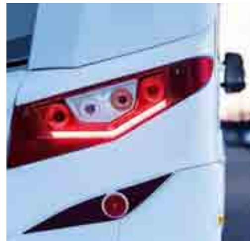
+ Seguridad por la noche: pilotos traseros integrales Innoluna con luz nocturna de LED
