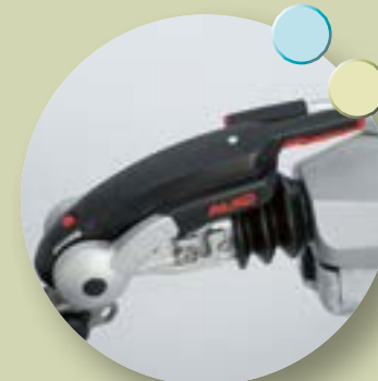
Seguridad durante el viaje gracias al dispositivo de freno de inercia y al AKS (opcional en Tourist)
