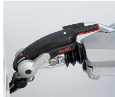
+ Seguridad durante el viaje gracias al dispositivo de freno de inercia y al AKS
