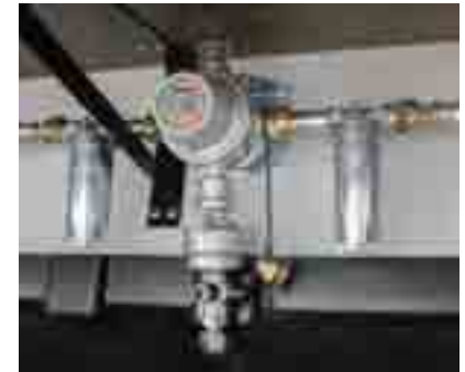
+ Regulador de gas con sensor de colisión y sistema EisEx (opcional)
