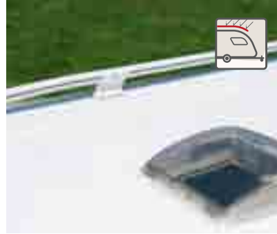
+ Techo, frontal y trasera de resistente GFK
