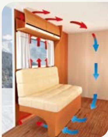
► El sistema AirPlus evita la condensación de agua
