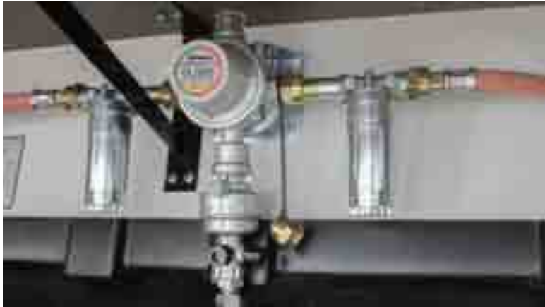
+ Regulador de gas Duocontrol con sensor de colisión
