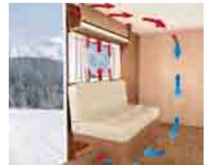
+ Sistema Air-Plus para la circulación de aire detrás de los armarios altos
