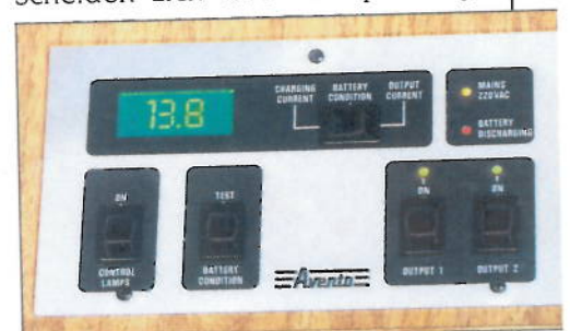
Het bedienings- en controlepaneel van de transformator/acculader.
