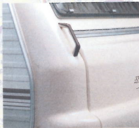
Design "2000", een glasvezel versterkt polyester vormstuk mede ontworpen en geproduceerd door Poly Products BV in Werkendam.
