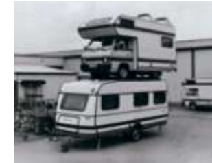
Se diseña la innovadora carrocería PUAL que hace prueba de su estabilidad.
