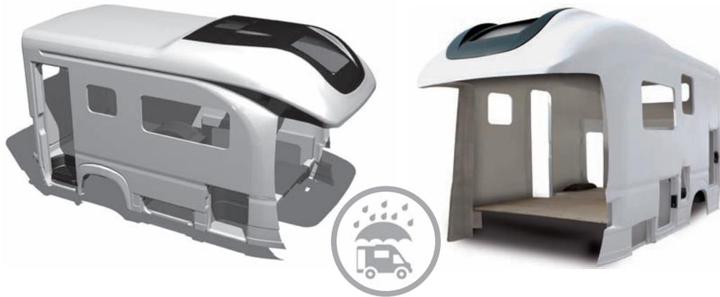
Dal 1977 Wingamm è il produttore n°1 al mondo di camper con carrozzeria monoscocca in vetroresina. Monoscocca in vetroresina, come dice la parola stessa, significa struttura stampata in unico blocco senza alcuna giuntura.
