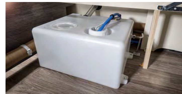
Réservoir eau fraîche facile d'accès
